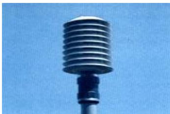
Mini abri comportant Un capteur de température
