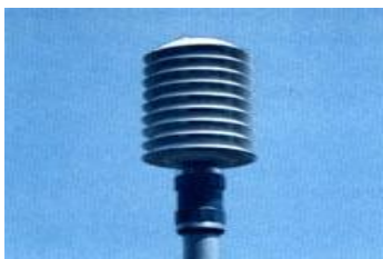
Mini abri comportant Un apteur d'humidité
